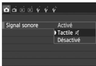
Si [**📷 1 : Signal sonore**] est réglé sur [**Tactile** 🔊], le signal sonore ne sera pas émis pendant les opérations tactiles.
