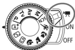
L'enregistrement vidéo est activé en positionnant le commutateur d'alimentation sur
