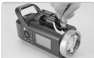
1. Insérez une pièce de monnaie ou une clé correspondante (non fournie) dans la vis de fixation du support et desserrez-la dans le sens contraire des aiguilles d'une montre pour la démonter.
