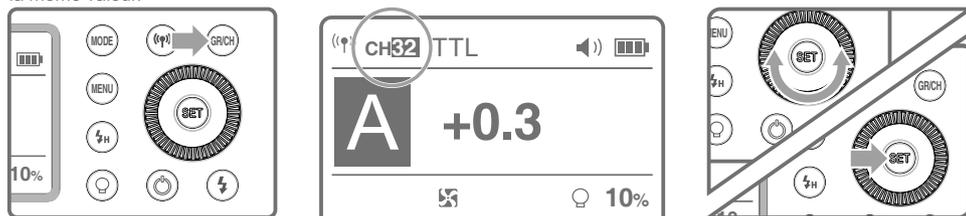
1 Appuyez et maintenez sur le bouton <GR/CH> pendant 2 secondes, pour que ID des canaux s'affiche sur le panneau LCD.the LCD panel.
