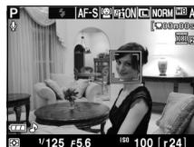
**AF zone large et zone normale :** l'appareil photo effectue la mise au point du sujet situé dans le point AF sélectionné lorsque vous appuyez à mi-course sur le déclencheur.
