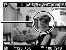
**AF zone large et zone normale :** utilisez le sélecteur multidirectionnel pour déplacer le point AF à n'importe quel emplacement du cadre ou appuyez sur **OK** pour positionner le point AF au centre du cadre.
