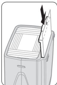
Sortez le réflecteur blanc et le diffuseur grand-angle intégré et, tout en maintenant le réflecteur blanc, remplacez le diffuseur grand-angle intégré en place à l'intérieur de la tête de flash.
