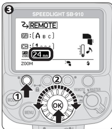
3 Appuyez sur la commande de fonction 1 pour mettre en surbrillance le réglage du réflecteur zoom, choisissez la position avec la molette de sélection, puis appuyez sur la commande [OK].
