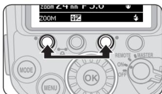
Appuyez sur les commandes de fonction 1 et 3 (un point vert figure à côté de chaque commande) simultanément pendant 2 secondes pour réinitialiser tous les réglages à leurs valeurs par défaut, sauf les réglages personnalisés.
